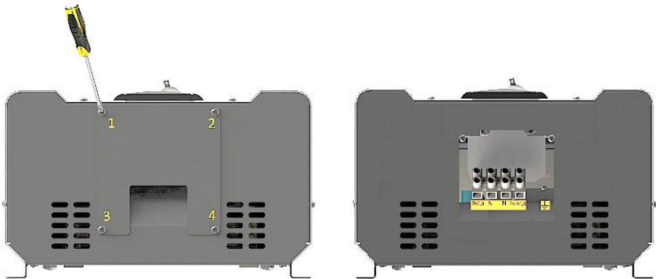
Рисунок 13. Схема снятия защитной крышки снизу корпуса стабилизатора
